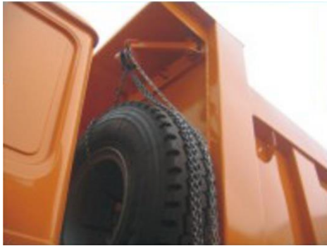
Рис.17 Механизма подъема ручного управления с цепной талью
