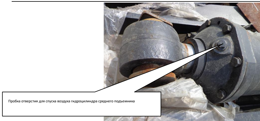
Рис.22 Расположение отверстия для спуска воздуха гидроцилиндра среднего подъемника
