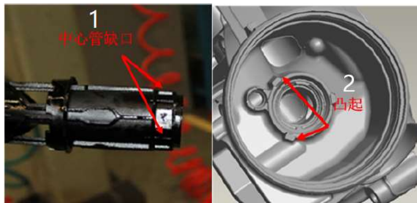
1 – Выемки на центральной трубке 2 – Выступы
