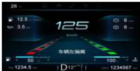
Отклонение за пределы левой полосы дорожной разметки
