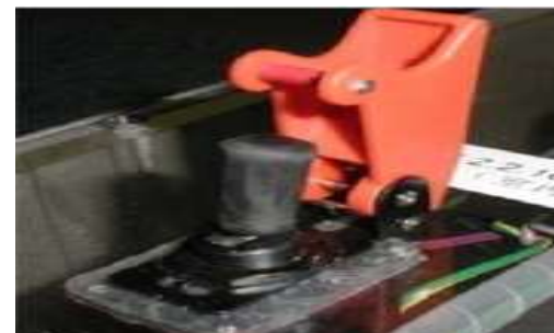
Переключатель S2/S3 в состоянии экстренного отключения питания
