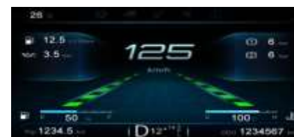
Обнаружены обе линии дорожной разметки
