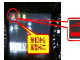
Индикатор понижения уровня охлаждающей жидкости до критического значения
