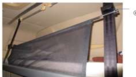
Защитная сетка верхнего спального места в разложенном положении
