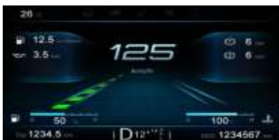
Обнаружена только левая линия дорожной разметки
