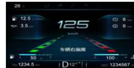
Отклонение за пределы правой полосы дорожной разметки
